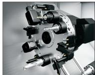
Le modèle ST-20SS est équipé d'une tourelle hybride 24 postes acceptant les outils à chaise, les outils d'un diamètre extérieur de 19 mm et les outils VDI 40.
